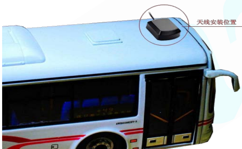
图 2-6 天线安装图示
